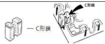
**C 形鎖**從底部水平地牢固兩塊平磚
