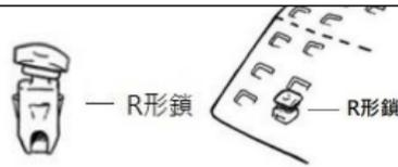
**R 形鎖**則固定斜板傾斜部分的最外側
